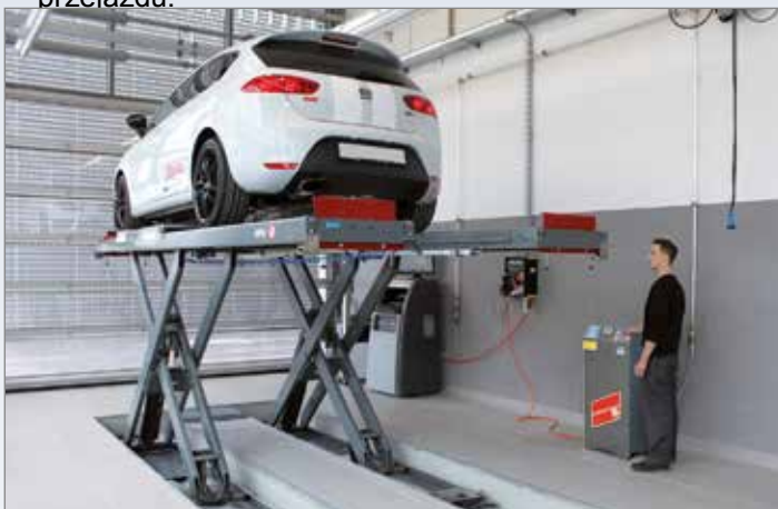
Wysokość użytkowa min. 1850mm przy montażu w fundamencie pasowym
