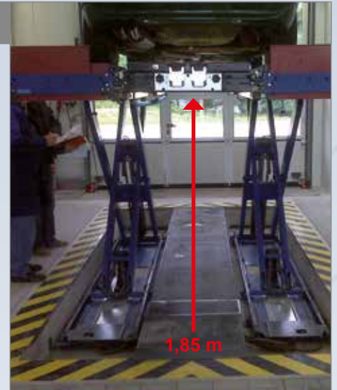
Platforma środkowa umożliwia użytkową wysokość podnoszenia na poziomie 1850 mm
