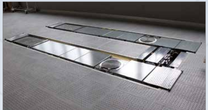
DUO CM w fundamencie pasowym (wersja do pomiarów geometrii)
