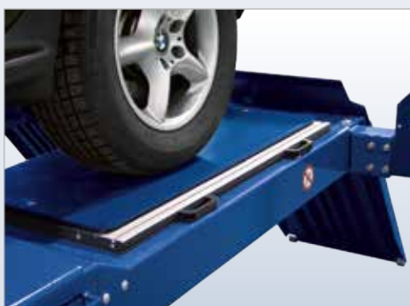
Precyzyjne płyty rozprężne (opcja, tylko dla wersji „W”); Minimalny moment rozprężenia 5 Nm i minimalna siła przesunięcia 15 N przy 500 kg nacisku na koło, duża ilość kólek stalowych, utwardzone bieżnie, rowki odprowadzające kapiącą z pojazdu wodę.
