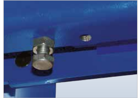
Trawers poprzeczna jest poziomowana w stosunku do posadzki za pomocą śrub nastawnych (przy opuszczonym podnośniku).
